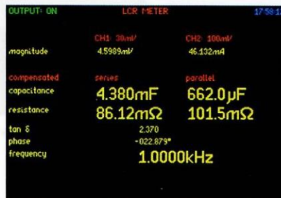
Figuur 14 en 15. De PSM3750 registreert een serieweerstand van 86 mΩ; let op de reactantie van 36 mΩ, gelijk aan 4,4 mF.
